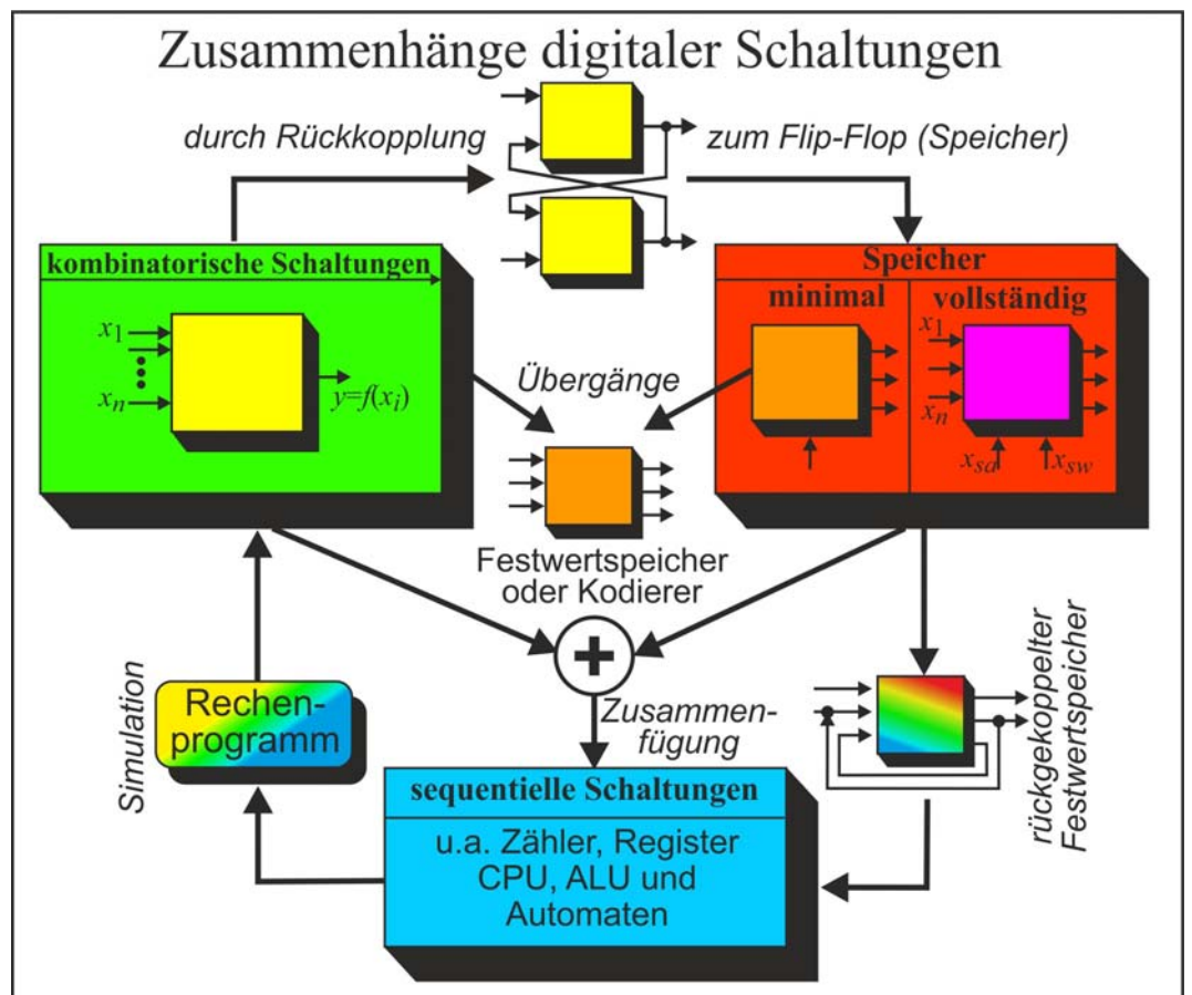
Bild 40. Kombinatorische Schaltung und der Speicher als Ausgangsschaltungen für alle weiteren binären Schaltungen.
